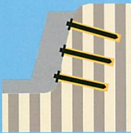
(1)土留アンカー
